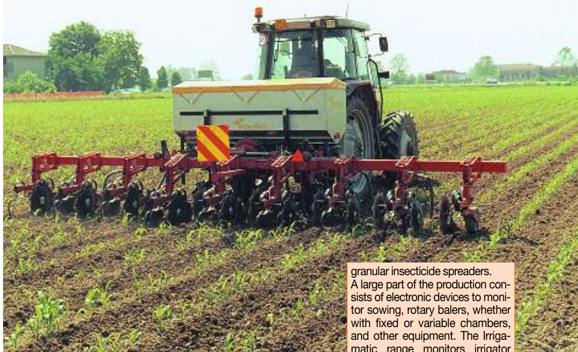
Sarchiatrice a 8 file da mais con spandiconcime a distribuzione pneumatica (mod. Unica)/The Unica, an 8-row hoe for maize with fertilizer spreader using air distribution
